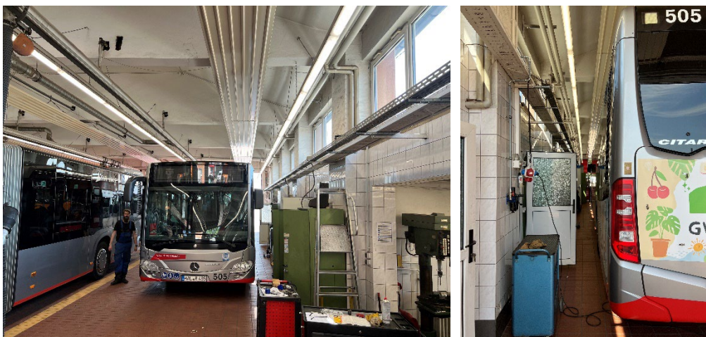
Abbildung 8-2 Seitliche Abstände bei der Belegung der linken Spur
